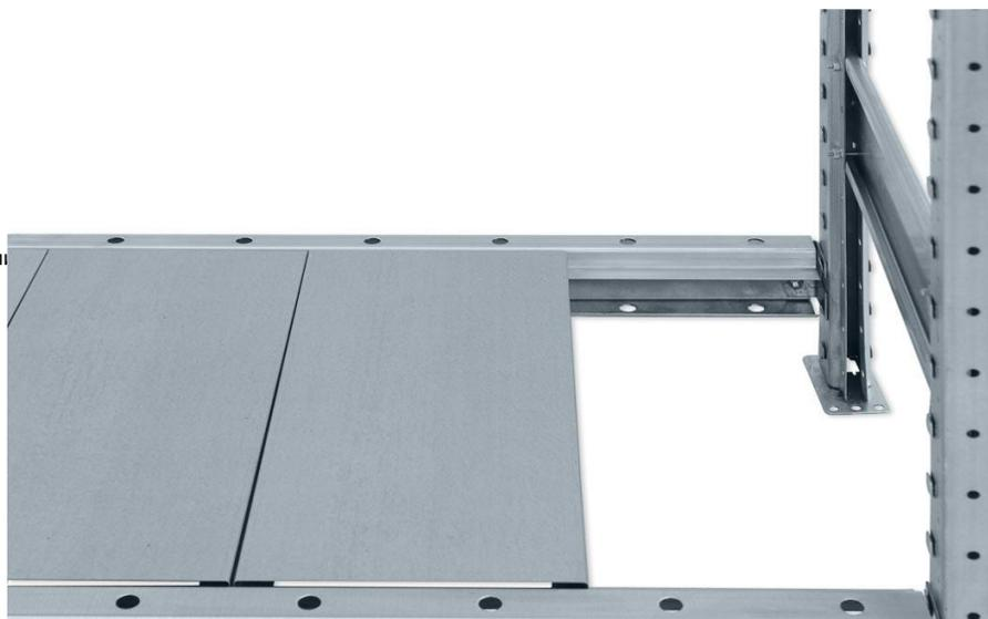
Производится из металла 0,7-1,0 мм. Толщина металла определяется максимальной распределённой нагрузкой на ярус хранения.
