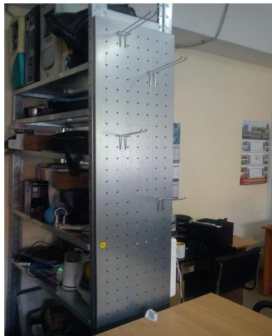
Выполняется из оцинкованной стали толщиной 1; 1,5; 2мм. Шаг перфорации 50x50мм. Диаметр 6мм. Ширина - по глубине рамы или спаренных рам. Высота: 1000-2000 мм.
